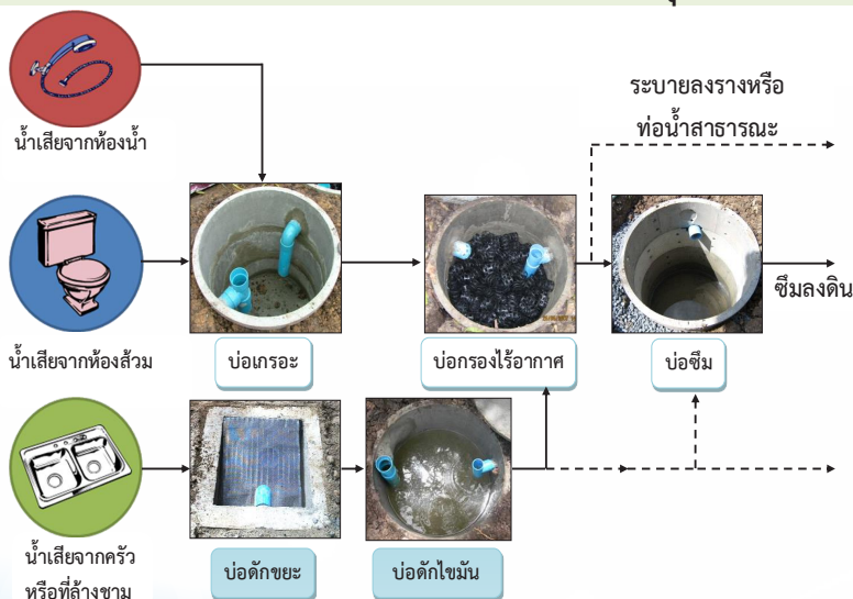
รูปที่ ๓.๓ การรวบรวมน้ำเสียมาบำบัดที่จุดเดียว
